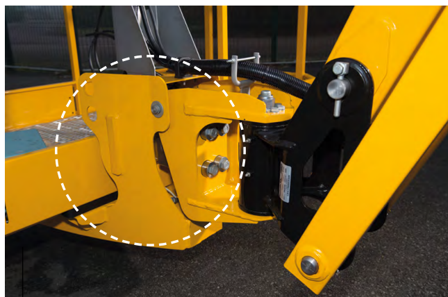
SYSTÈME DE PESAGE PROTÉGÉ dans la pièce de liaison
