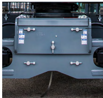
Vérins de directions protégés à l'intérieur du châssis
