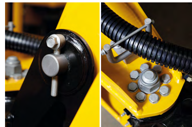
TRAITEMENT ANTI-CORROSION des axes, de la visserie et des pièces peintes. Résistance aux tests salins sur plus de 500h
