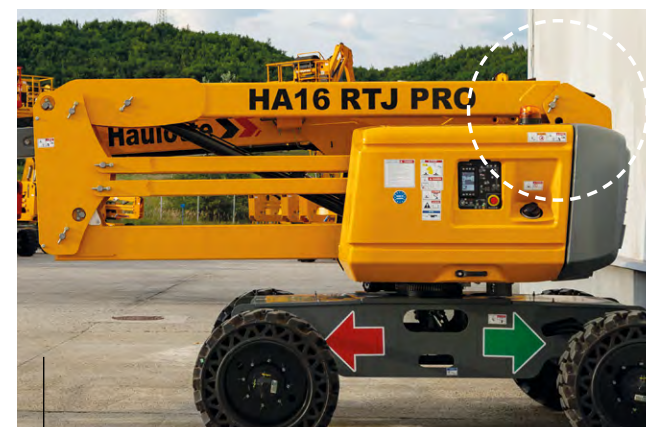
FLÈCHE PROTÉGÉE dans le gabarit du contrepoids
